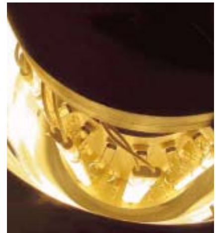
Erwärmen von Kompressorgehäusen von innen
