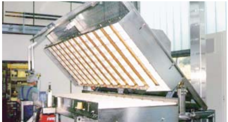
Wärmebehandlung von Glasfasermaterial vor der Weiterbehandlung
