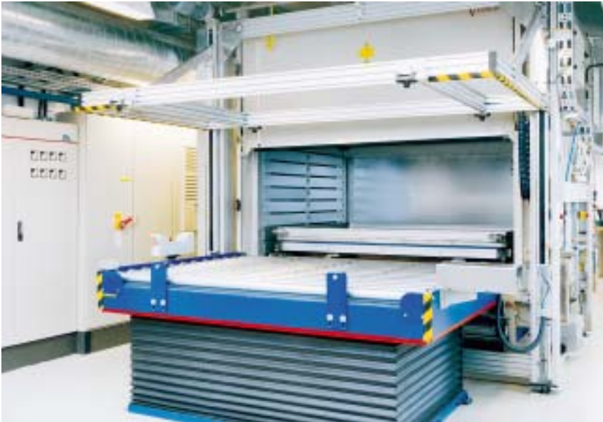
2-Zonen-Durchlauföfen zum Aushärten von Kohlefaser-Verbundwerkstoff-Komponenten
