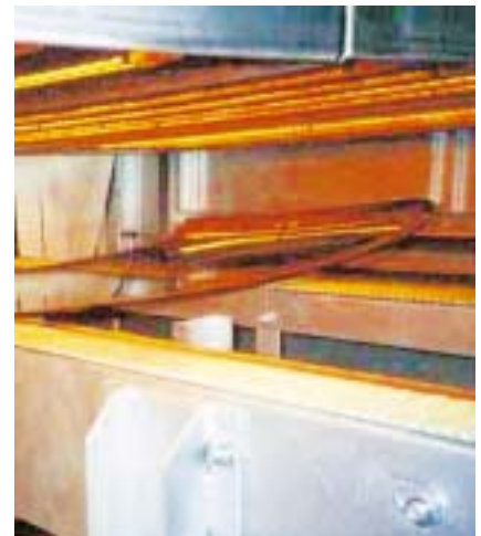
Erwärmen der Ränder von Autoscheiben zur besseren Haftung von PU-Schaum
